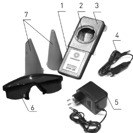
Рисунок 1. Внешний вид облучателя ОУФ-06 «Солнышко»
